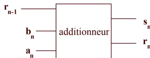
L'addition de deux bits peut être réalisée simplement à l'aide de deux portes NAND et une porte OU-EXCLUSIF.
