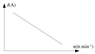
Pour tracer cette caractéristique à U et f constants, on charge progressivement le moteur asynchrone grâce à un frein à poudre ou à une dynamo balance. Au fur et à mesure que l'on charge le moteur, ce dernier appelle un courant donc une puissance électrique plus importante.
