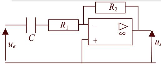
**THEORIE** : déterminer la transmittance (ou fonction de transfert)  $T_0 = \frac{U_s}{U_e}$  en fonction de  $R_1$ ,  $R_2$ ,  $C$  et  $f$ .
