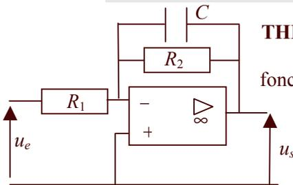
**THEORIE** : déterminer la transmittance (ou fonction de transfert)  $T_1 = \frac{U_s}{U_e}$  en fonction de  $R_1$ ,  $R_2$ ,  $C$  et  $f$ .
