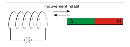
Au cours du déplacement de l'aimant droit vers la bobine, l'aiguille du galvanomètre dévie. Eloignons ce pôle de la bobine, la déviation s'inverse. Elle s'inverse aussi si on permute les pôles de l'aimant. La déviation est d'autant plus grande que le déplacement est rapide.
