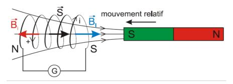
Au cours de l'expérience, le circuit fermé fait apparaître la circulation d'un courant lors du déplacement de l'aimant. Ce courant est appelé courant induit.
