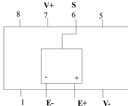
Les tensions de polarisation sont fournies par une alimentation extérieure. L'alimentation comporte un point milieu. Ce point milieu doit être relié à la masse du montage.
