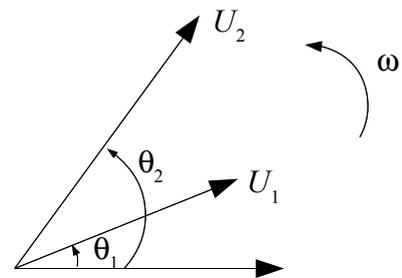
Les vecteurs, tournant à la même vitesse angulaire  $\omega$ , sont immobiles l'un par rapport à l'autre: l'angle  $(\vec{U}_1, \vec{U}_2)$  reste donc constant. On l'appelle différence de phase entre  $u_1$  et  $u_2$  et on le note:  $(\vec{U}_1, \vec{U}_2) = \varphi_{u_2/u_1} = \Theta_2 - \Theta_1$
