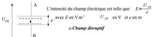
Au delà d'une certaine intensité, le champ électrique peut provoquer la destruction du diélectrique: ce champ maximal est appelé champ disruptif.
