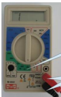
Régler le sélecteur du multimètre sur la position 200 Ω
