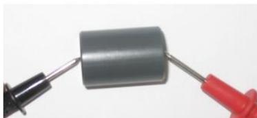
Positionner l'échantillon à plat et **mettre** en contact chaque extrémité de celui-ci avec les pointes du multimètre.
